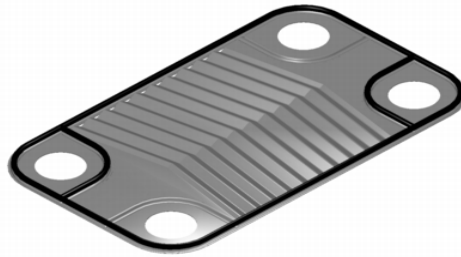
Illustration 3: Spårmonster på värmeväxlar plattor
